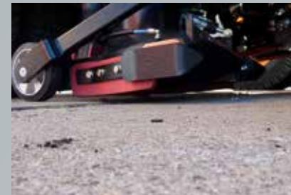
Elevación neumática de tobera de aspiración
