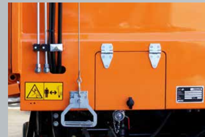
Cable de acero para limpiar el filtro de hojas
